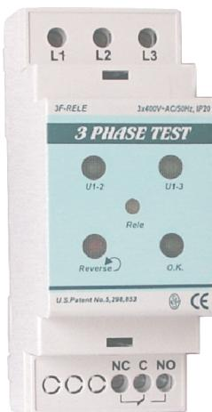
Tento přístroj slouží k vizualizaci 3f napěťové soustavy s možností využití kontaktu rele. Přístroj je v modulovém provedení (šířka 2 modulů). Najde uplatnění např. u čerpadel, výtahů, dopravníků ap., kde potřebujeme chránit zařízení před spuštěním v opačné rotaci připojené sítě, nebo se ztrátou fáze. Přístrojem lze také dohledat fázi, která nám schází, nebo správně nařazovat dva 3f systémy ap.
